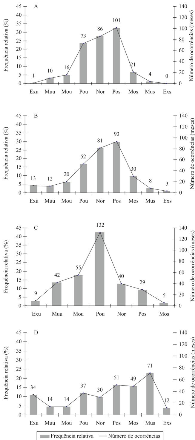
**Figura 2.** Frequência relativa e número de ocorrências dos valores obtidos no cálculo dos índices de seca PDSI (A), Z-index (B), SPI (C) e RAI (D), em diferentes classes de umidade: Exu, extremamente úmido; Muu, muito úmido; Mou, moderadamente úmido; Pou, pouco úmido; Nor, normal; Pos, pouco seco; Mos, moderadamente seco; Mus, muito seco; Exs, extremamente seco.
