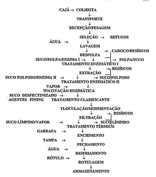
FIG. 1. Fluxograma do processamento de suco ciarificado de cajá (Spondias lutea L.).
