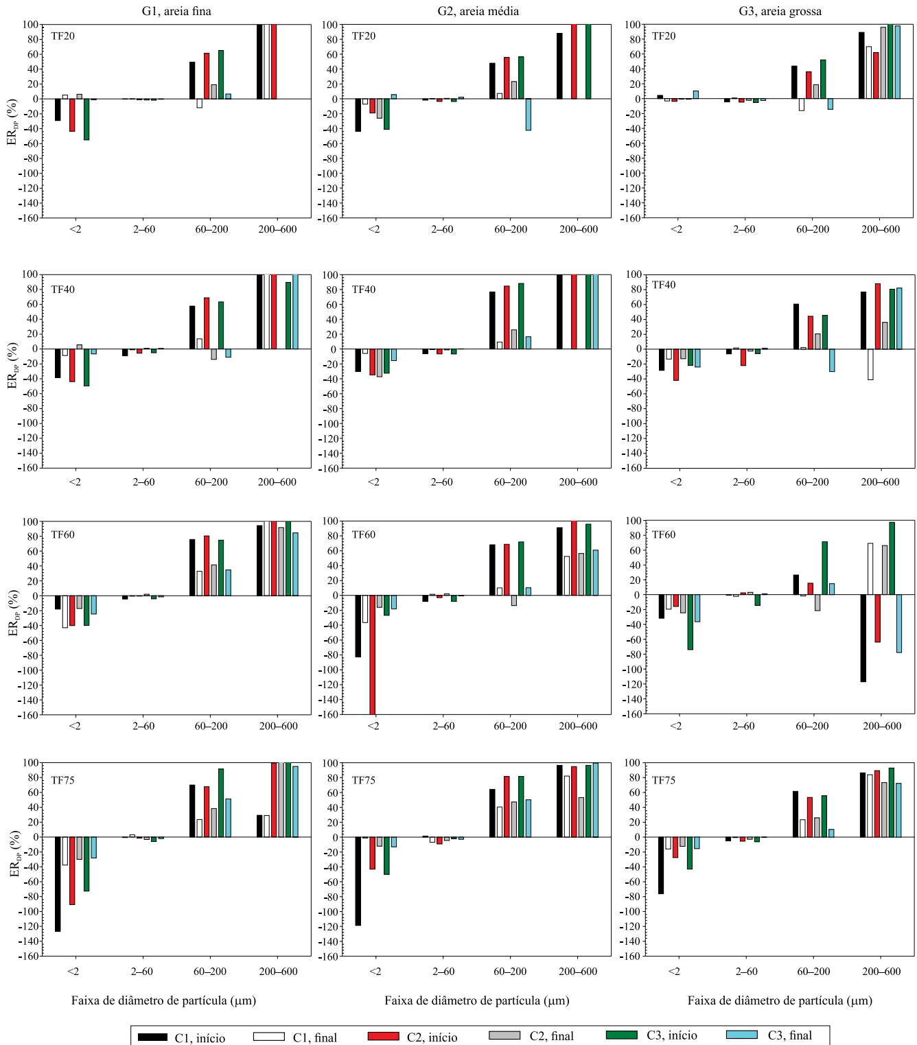
Figura 2. Variação média da eficiência de remoção ( ER_{DP} ) no processo de filtração, para as faixas de diâmetro de partículas contidas na água, para as diferentes combinações de granulometria de areia no filtro, taxas e ciclos de filtração, no início e no fim do processo. TF20, TF40, TF60 e TF75 referem-se, respectivamente, às taxas de filtração de 20, 40, 60 e 75 m^3 m^{-2} h^{-1} ; e G1, G2 e G3 referem-se, respectivamente, às granulometrias de areia fina, D_{10}=0,55 mm; média, D_{10}=0,77 mm; e grossa, D_{10}=1,04 mm.
