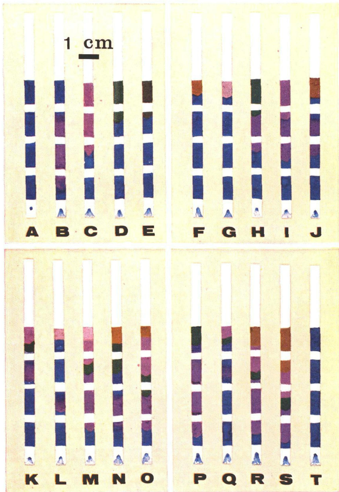
FIG. 1. "Spot tests" cromatográficos apresentando as faixas reativas de cinco diferentes cátions. A) papel reagente; B) magnésio; C) alumínio; D, E) manganês; F) ferro-ferroso; G) oxônio; H) manganês e magnésio; I) alumínio e magnésio; J) ferro-ferroso e magnésio; K) alumínio, manganês e magnésio; L) oxônio e magnésio; M) oxônio, alumínio, manganês e magnésio; N) ferro-ferroso, manganês e magnésio; O) ferro-ferroso, alumínio, manganês e magnésio; P, Q, R, S) cromatografias das camadas I, II, III e IV de um Glei húmico do Amapá; T) controle.
