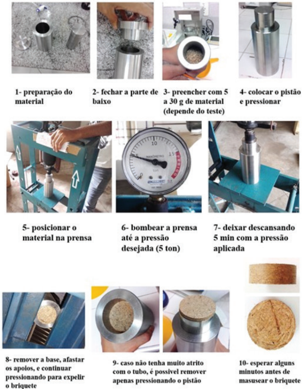
Figura 18. Etapas para utilização do molde briquetador.
