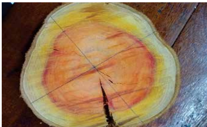
Figura 5. Esquema de um tipo de amostragem que representa a variabilidade do tronco da árvore.
