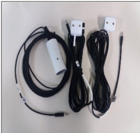
Figura 3: Detalhe do equipamento SRS NDVI Hemisférico e com Limitador de Visão instalado na lavoura experimental em Carazinho, RS, safra 2017/18.
